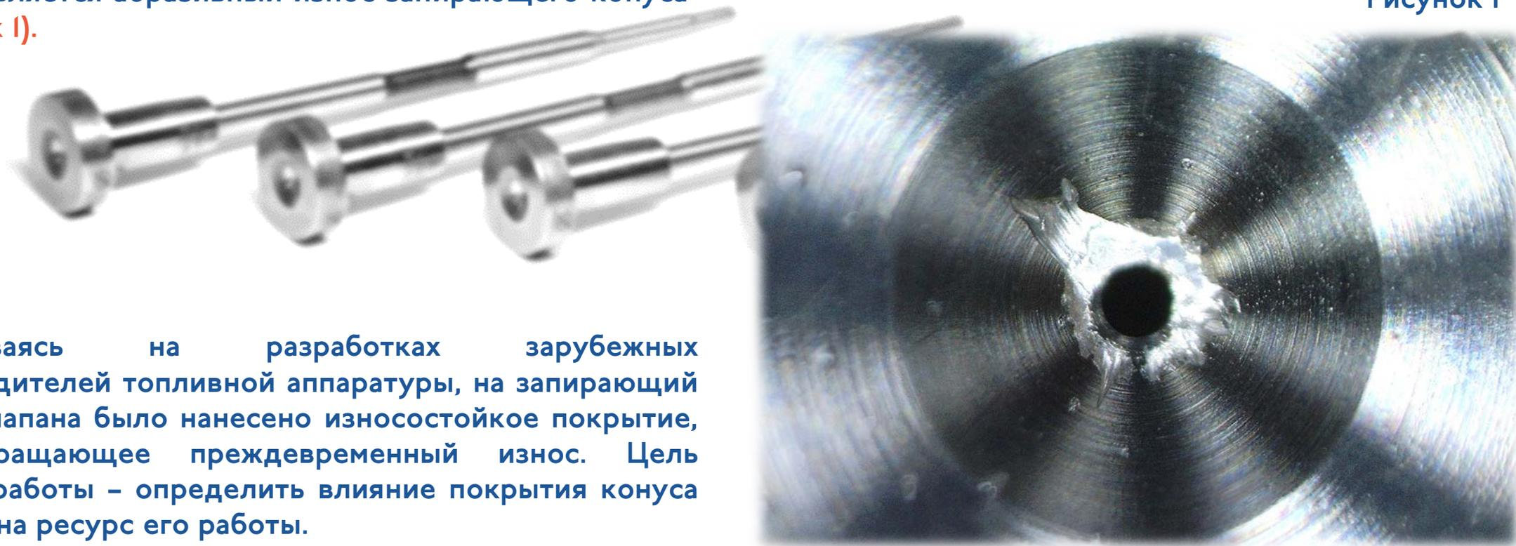
Основываясь на разработках зарубежных производителей топливной аппаратуры, на запирающий конус клапана было нанесено износостойкое покрытие, предотвращающее преждевременный износ. Цель данной работы – определить влияние покрытия конуса клапана на ресурс его работы.
